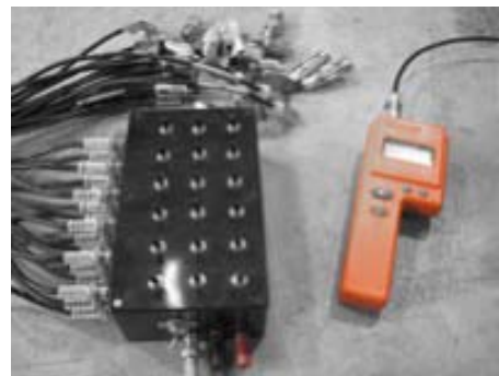
Figure 3. Multiplexeur et capteur Delmhorst utilisés pour mesurer la TEE par les sondes.
